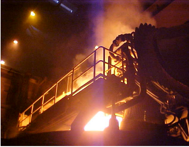
صورة (2) عملية سحب الأقطاب الكربونية من الفرن وانبعاث الأبخرة
